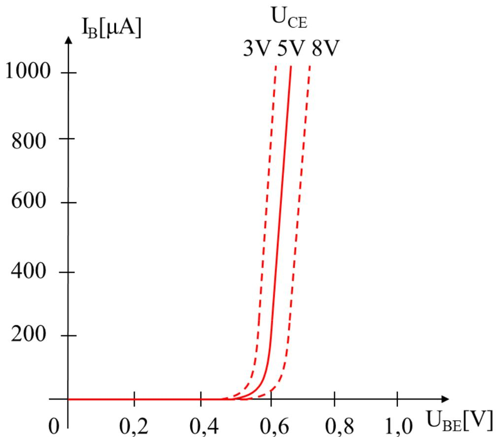
Ako je veći napon  $U_{CE}$ , veće će biti električno polje između kolektora i baze, pa će kolektor da "usisava" veći broj elektrona, samim tim struja baze će biti manja a struja kolektora veća.
